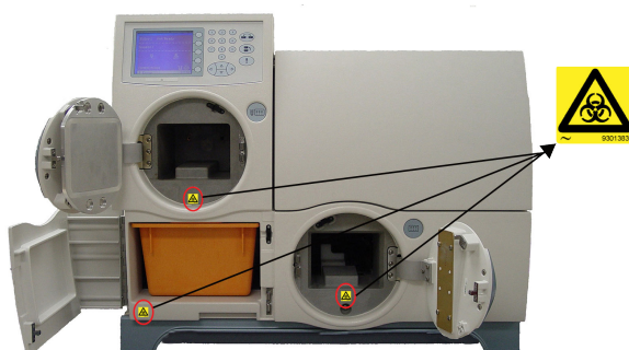
Rysunek 6: Etykieta przestrogi o zagrożeniu biologicznym – drzwiczki do napełniania, składowania odpadów i wkładania
