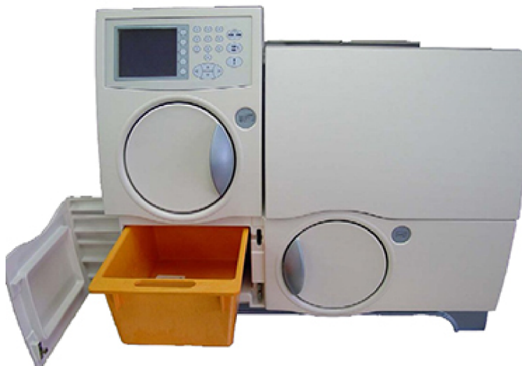
Rysunek 52: Stacja składowania odpadów (otwarta)
