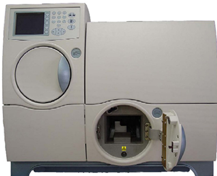
Rysunek 18: Drzwiczki do wkładania i wyjmowania kasety – drzwiczki wkładania
